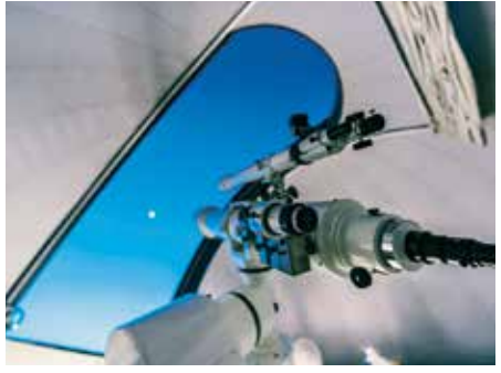
▶13等星まで観測できるレンズ口径20cm屈折式天体望遠鏡（野崎遼平さん提供）
